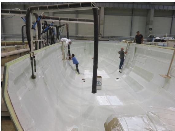
Dans ce bâtiment nous voyons la mise en œuvre de technologie nouvelle telle que l'injection de la résine entre le moule et le contre moule par dépression pour la réalisation de la coque et du pont (opération très délicate car un défaut de répartition de résine entraîne la destruction de l'ouvrage)
